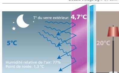
Grâce à la couche d'oxydes métalliques déposée sur la face externe du verre, qui agit comme un "réflecteur de froid", la température de la face externe du vitrage (4,7°C) reste supérieure au point de rosée (1,3°C). Il n'y a aucune formation de condensation.
