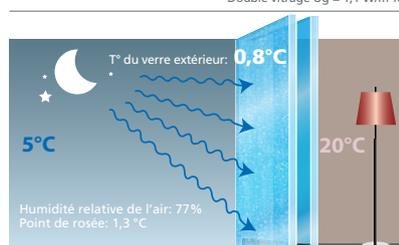
Dû au pouvoir isolant du vitrage et à un ciel froid, la face externe du vitrage devient relativement froide. Dès que sa température est inférieure au point de rosée (1,3°C), de la condensation se forme.
